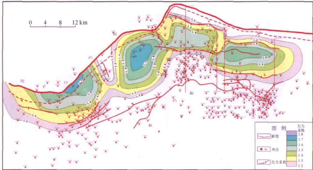
图 7 车镇凹陷 Es3 下亚段异常高压带最大压力段压力系数平均值平面图
