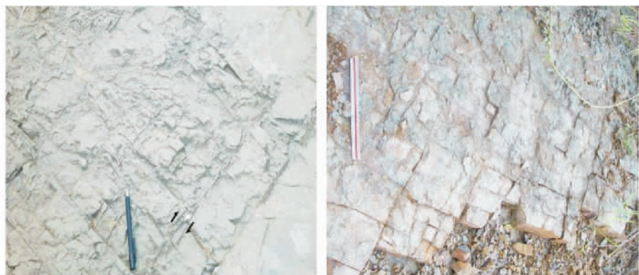
图 5 莱阳期末东西向挤压产生的共轭节理
